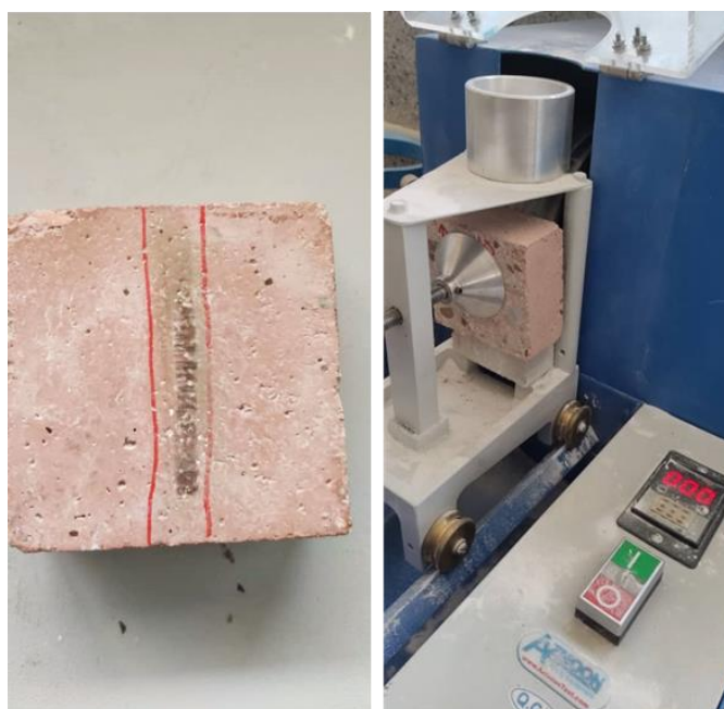
شکل ۱۴ تست سایش روی سطح نمونه بتن رنگی
