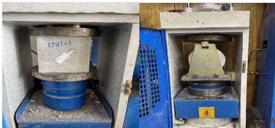
شکل ۵: آزمایش مقاومت فشاری و کششی بتن
