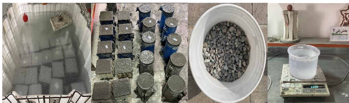
شکل ۳: توزین مصالح، ساخت و عمل آوری
