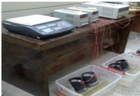
شکل ۱: تصویر نحوه آزمایش مهاجرت تسریع شده یون کلراید
