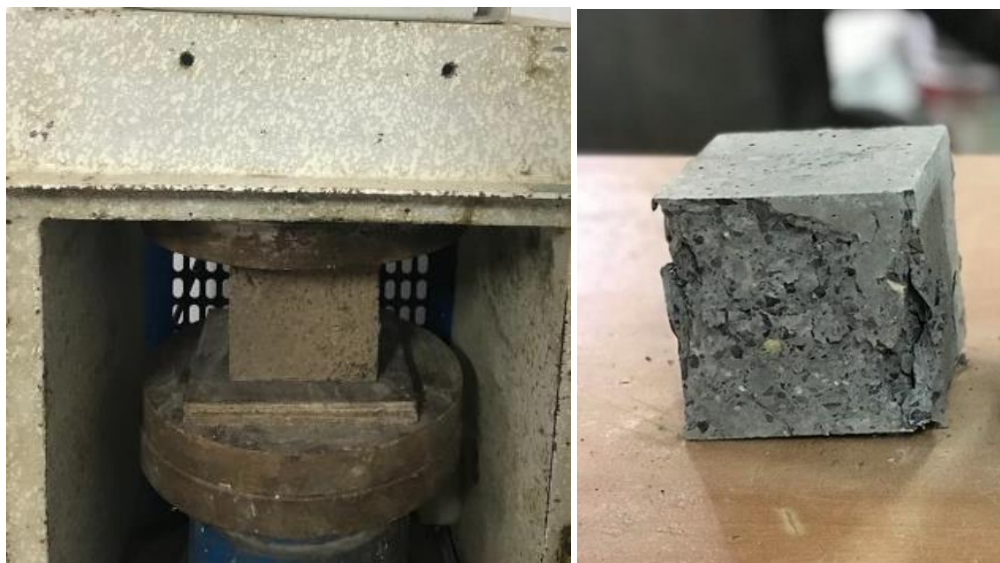
شکل ۸: تصویر شکست نمونه بتن ژئوپلیمری در سن ۷ روزه بعد از آزمایش مقاومت فشاری
