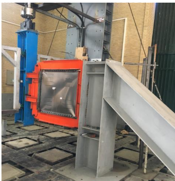
شکل ۳: نحوه انجام بارگذاری روی نمونه
