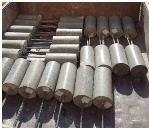
شکل ۴- نمونه‌های بتن جهت آزمایش بیرون کشیدن میلگرد
