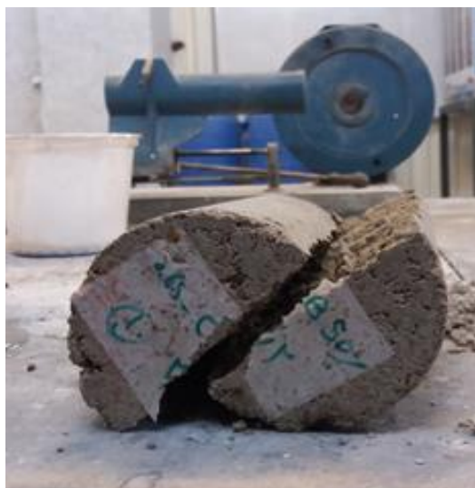
شکل ۱۲: نمونه استوانه‌ای تحت آزمایش مقاومت کششی
