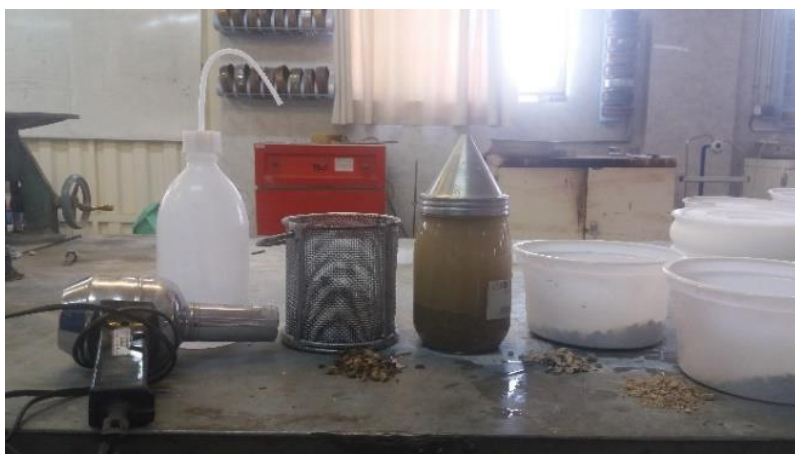
شکل ۴: وسایل آزمایش جذب آب مصالح سنگی (درشت‌دانه و ریزدانه)
