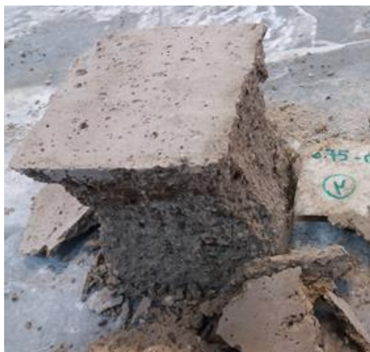
شکل ۱۰: نمونه مکعبی تحت آزمایش مقاومت فشاری
