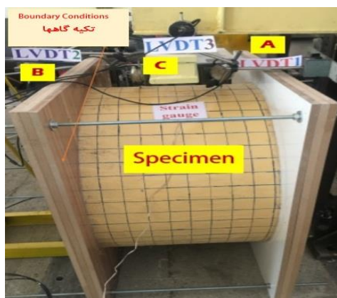
شکل ۴: سیستم Set up و ابزارهای اندازه گیری
