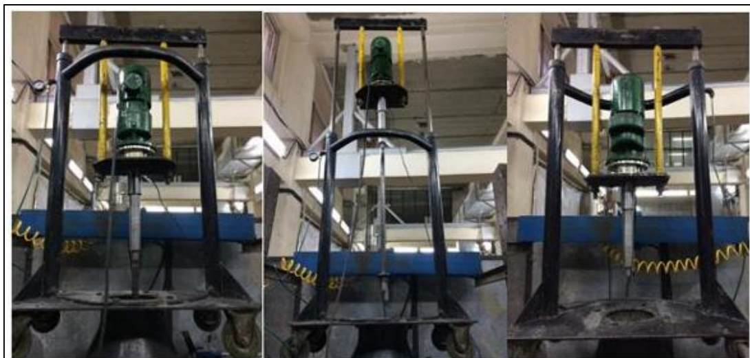
شکل ۱۰: نحوه اجرای شمع ها در دستگاه FCV-AUT
