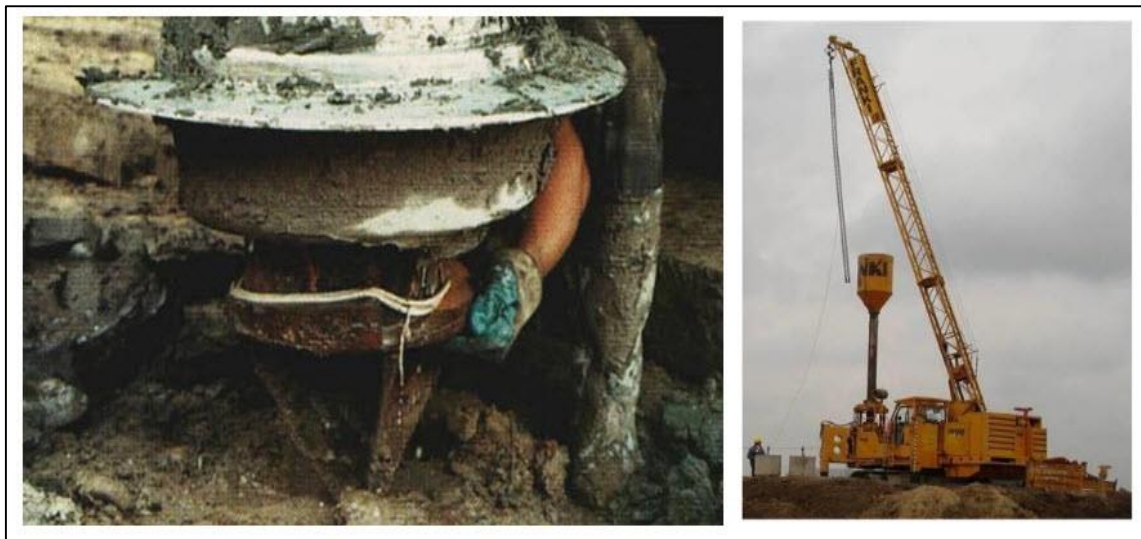
شکل ۲: تجهیزات حفاری شمع جابجایی - جایگزینی [۱۹]
