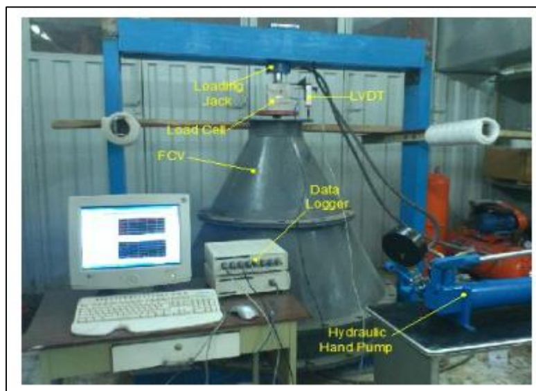
شکل ۹: تجهیزات مربوط به بارگذاری شمع
