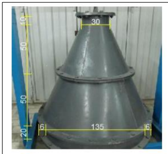
شکل ۸: دستگاه FCV-AUT به همراه ابعاد بر حسب سانتی متر
