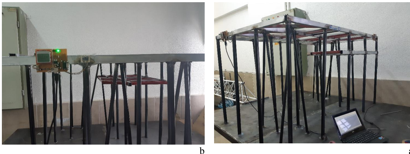
شکل ۴ مدل مورد مطالعه و تجهیزات مورد استفاده جهت آنالیز مودال تجربی.
