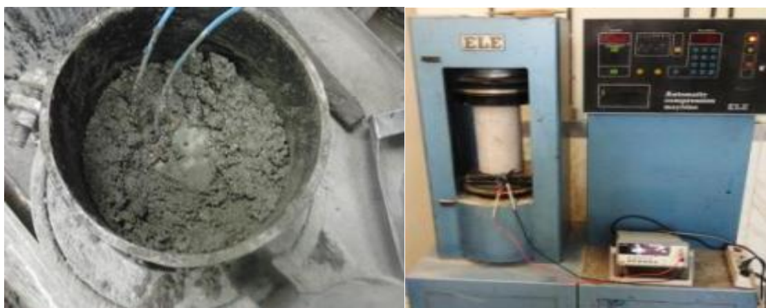
شکل ۶- جاگذاری حسگرهای فشارسنج الکتريکی بتنی داخل المان بتنی و آزمایش حسگر تا نقطه شکست
