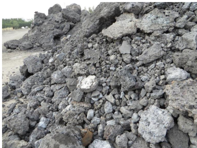
شکل ۱- نمونه سرباره خردشده با پیکور در کارخانه فولاد اهواز
