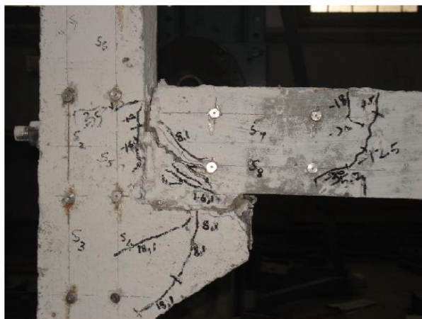
شکل ۱۱: الگوی ترک خوردگی نمونه دوم (SP2) [۳۱]
