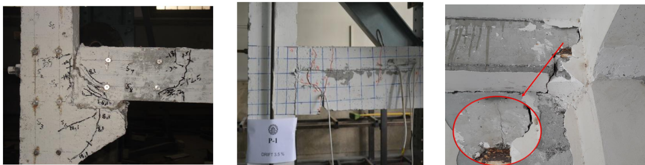
الف: الگوی ترک خوردگی ساختمان مورد بررسی ب: الگوی ترک خوردگی نمونه آزمایشگاهی اول ج: الگوی ترک خوردگی نمونه آزمایشگاهی دوم
