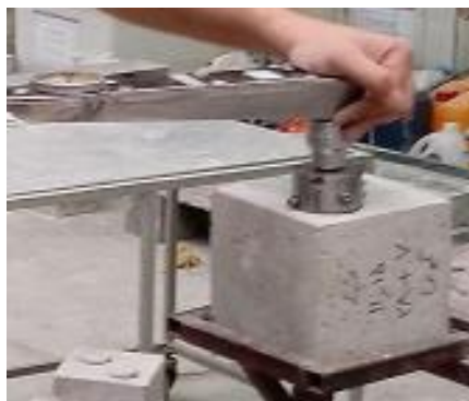
الف) اعمال لنگر پیچشی با ترک‌متر
