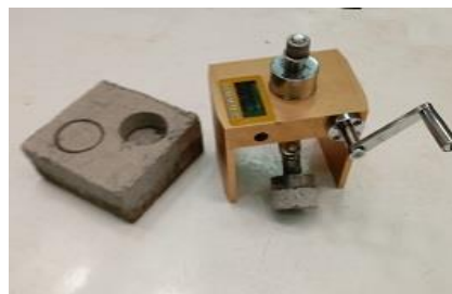
(الف) تعیین مقاومت چسبندگی کششی
