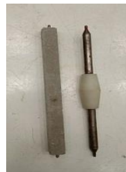
(الف) نمونه منشوری و میله استاندارد
