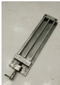
(ب) قالب تعیین جمع‌شدگی
