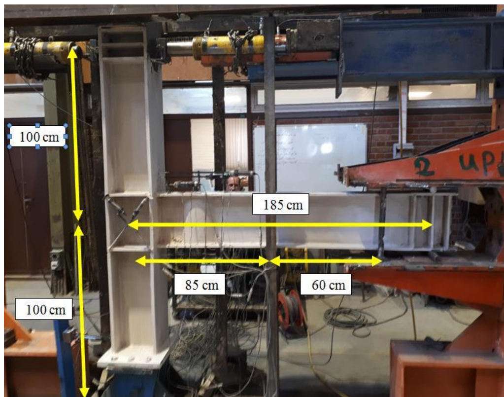
شکل ۵: ساختار برقراری تست و ابعاد کلی نمونه.
