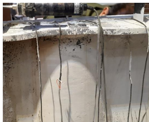
(d) 6% story drift in SW-RBS specimen
