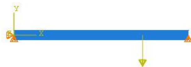
شکل ۲۰: نمایش تیر فولادی با شرایط تکیه‌گاهی و نحوه بارگذاری
