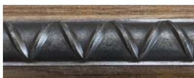
شکل ۲: هندسه آج‌های میلگردهای مورد استفاده در پژوهش
