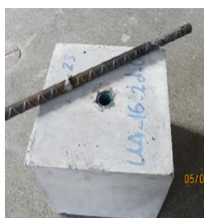
ب) حالت گسیختگی بیرون کشیده شدن میلگرد
