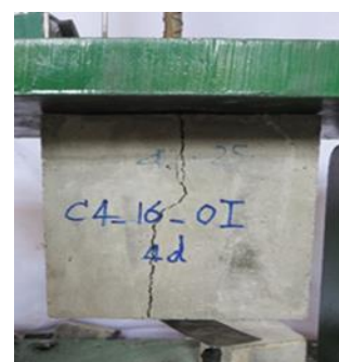
ج) حالت گسیختگی بیرون کشیده شدن میلگرد همراه با گسترش ترک به سطح (حالت ترکیبی)
