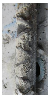
ب) حالت گسیختگی بیرون کشیده شدن میلگرد
