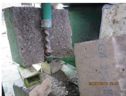
د) حالت گسیختگی شکافت بتن
