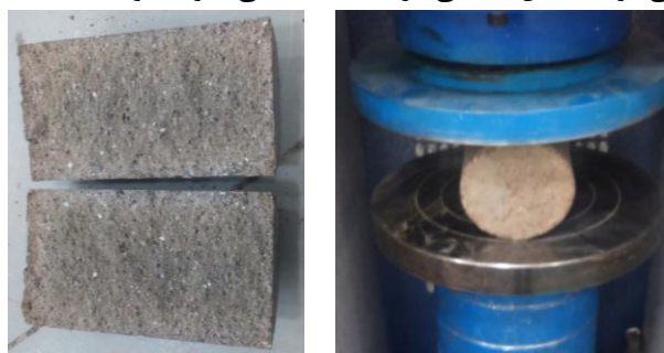
شکل ۵: نمونه استوانه‌ای تحت آزمایش کشش برزیلی
