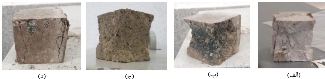
شکل ۴: نحوه شکست نمونه ملات ژئوپلیمر ساخته شده از متاکائولن (الف) و سرباره (ب-ج-د)
