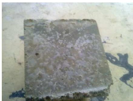
شکل ۱۱: لایه نانورس تشکیل شده بر وجه نمونه مکعبی پس از ۱۸۰ روز عمل‌آوری در نمونه حاوی ۱٪ نانورس
