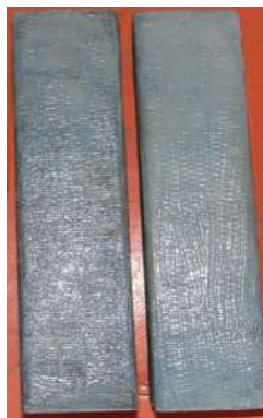
شکل ۲: مقاوم سازی نمونه ها با CFRP.
