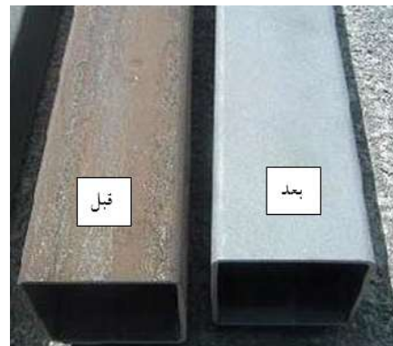
شکل ۱: نمونه ها قبل و بعد از سند بلاست.
