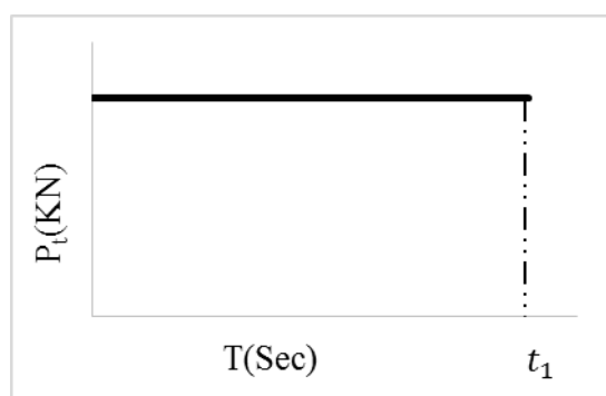
شکل ۱۷: بار ضربه‌ی ناشی از برخورد وسیله‌ی نقلیه به ستون قاب‌های مورد مطالعه
