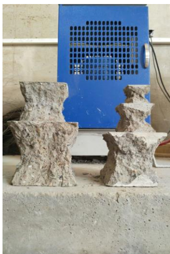
شکل ۴: وضعیت شکست نمونه‌های مکعبی با اندازه‌های مختلف پس از انجام آزمایش مقاومت فشاری
