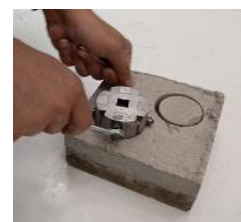
الف) تثبیت دستگاه "انتقال اصطکاک" بر روی مغزه جزئی
