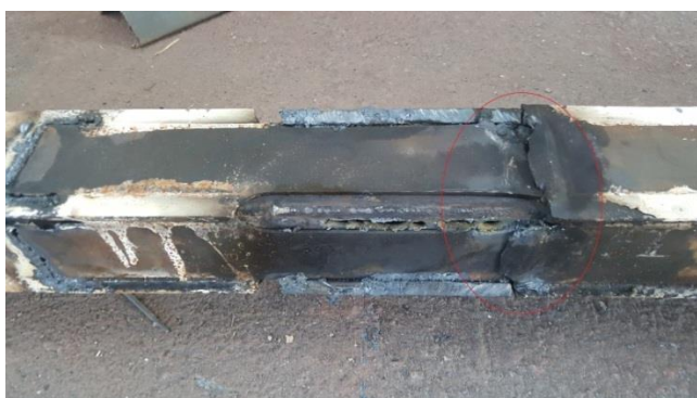
ب. پارگی مهاربند در انتهای فیوز
