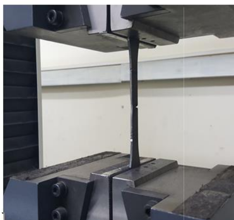
شکل ۹: آزمون تست کشش استاندارد مصالح فولادی
