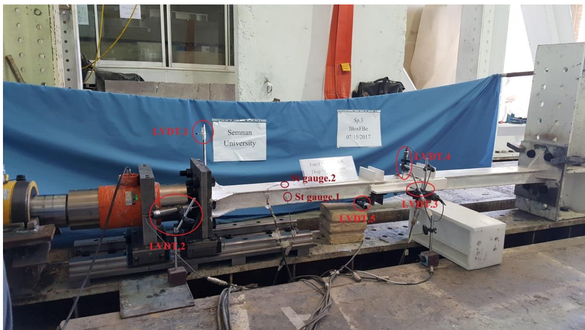
ب. مهاربندهای LF-AECB با مقطع I و ورق‌های تقویتی شکل ۷: ستاپ آزمایشگاهی
