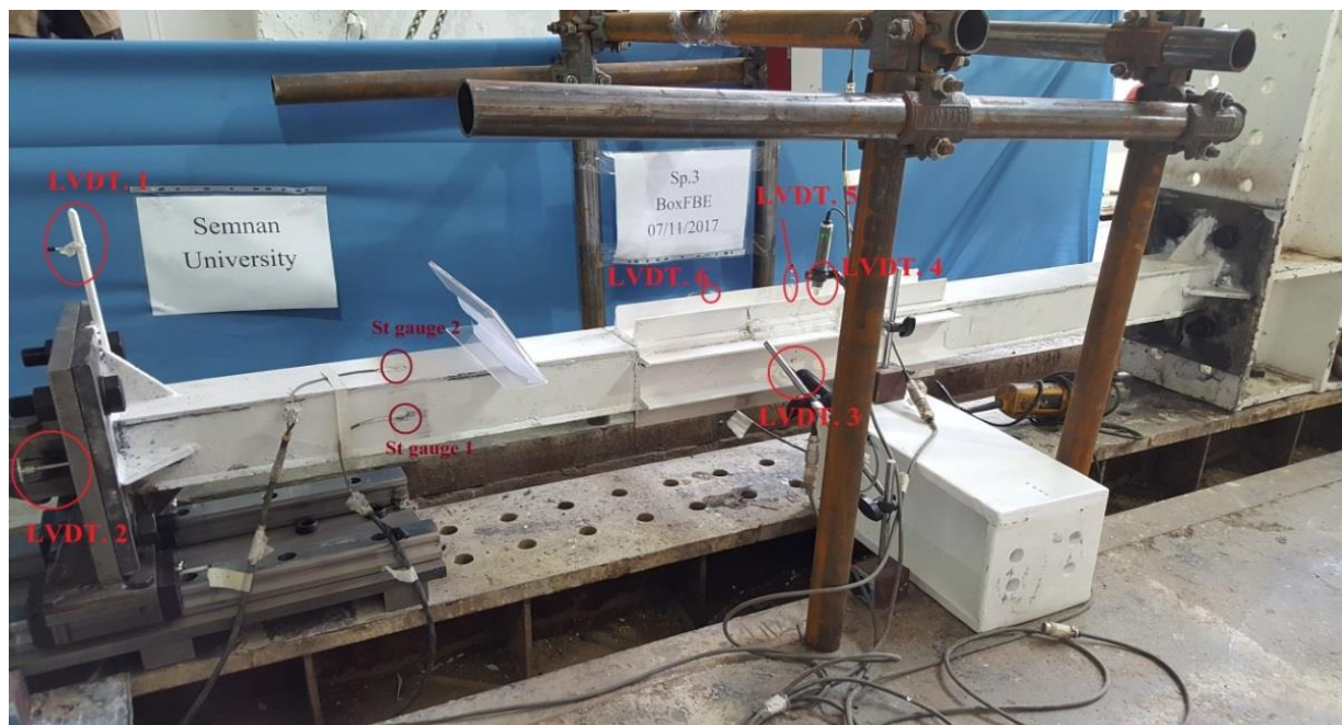
آ. مهاربندهای LF-AECB با مقطع باکس
