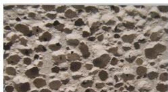
شکل ۸: بتن سبک اتوکلاو شده (پس از فرایند پخت در کوره)
