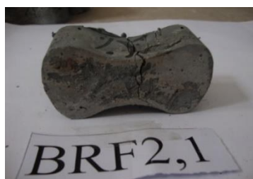
شکل ۹: یک نمونه RPC پس از آزمایش تعیین مقاومت کششی.
