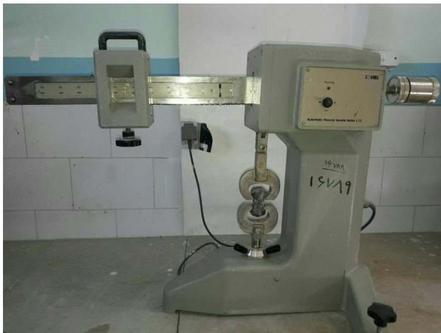
شکل ۸: دستگاه آزمایش نمونه‌های RPC برای تعیین مقاومت کششی.
