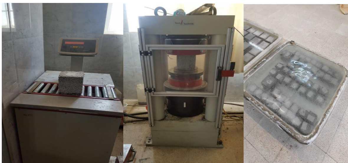
شکل ۵: به ترتیب از راست: ترازو، جک فشاری و نمونه‌ها در زمان عمل‌آوری
