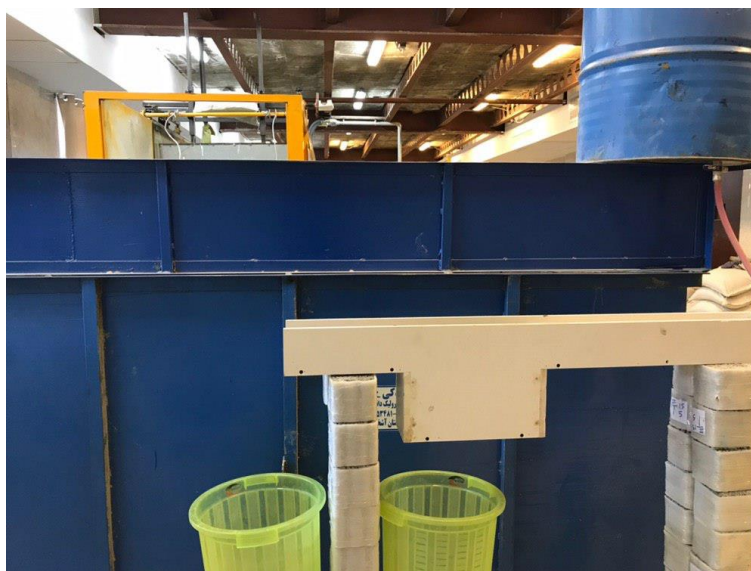
شکل ۳: سیستم اندازه گیری نفوذپذیری نمونه های بتن متخلخل
