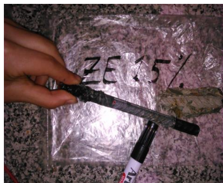
شکل ۱۳: نمونه حاوی ۱۵ درصد ژئولیت جایگزین سیمان پس از ۱۰۰ روز در محیط مشابه جذر و مد.
