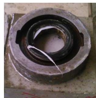
الف) صفحه فلزی چسبانده شده بر روی نمونه
