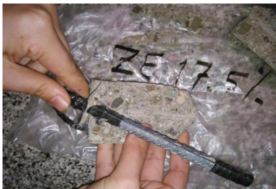
شکل ۱۰: نمونه حاوی ۱۷/۵ درصد ژئولیت جایگزین سیمان پس از ۱۰۰ روز در محیط مشابه جذر و مد.
