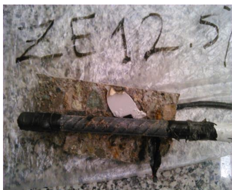
شکل ۱۲: نمونه حاوی ۱۲/۵ درصد ژئولیت جایگزین سیمان پس از ۱۰۰ روز در محیط مشابه جذر و مد.
