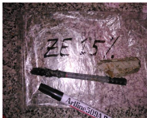
شکل ۱۳: نمونه حاوی ۱۵ درصد ژئولیت جایگزین سیمان پس از ۱۰۰ روز در محیط مشابه جذر و مد.
