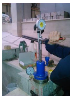
ب) انجام آزمایش "محفظه استوانه ای"
