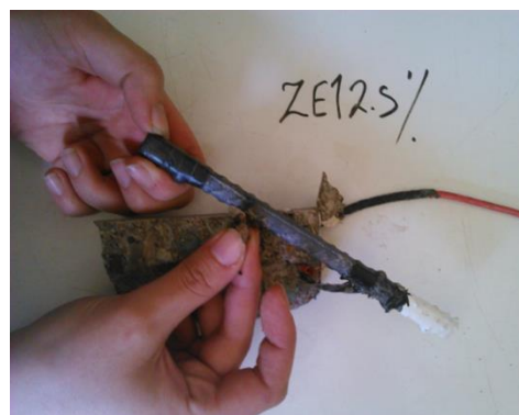
شکل ۱۲: نمونه حاوی ۱۲/۵ درصد ژئولیت جایگزین سیمان پس از ۱۰۰ روز در محیط مشابه جذر و مد.
