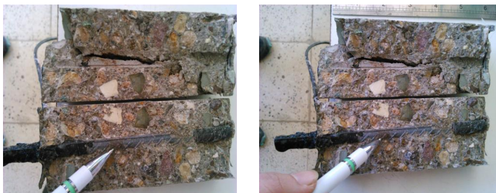
شکل ۱۴: نمونه کنترل پس از ۱۰۰ روز در محیط مشابه جذر و مد.
