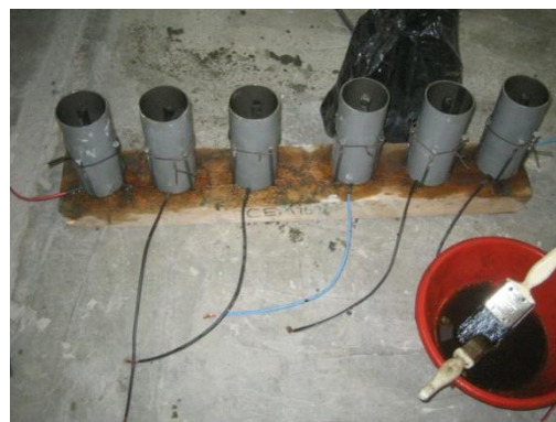
الف) قالب‌های ساخته شده جهت انجام آزمایش نیم‌پیل
