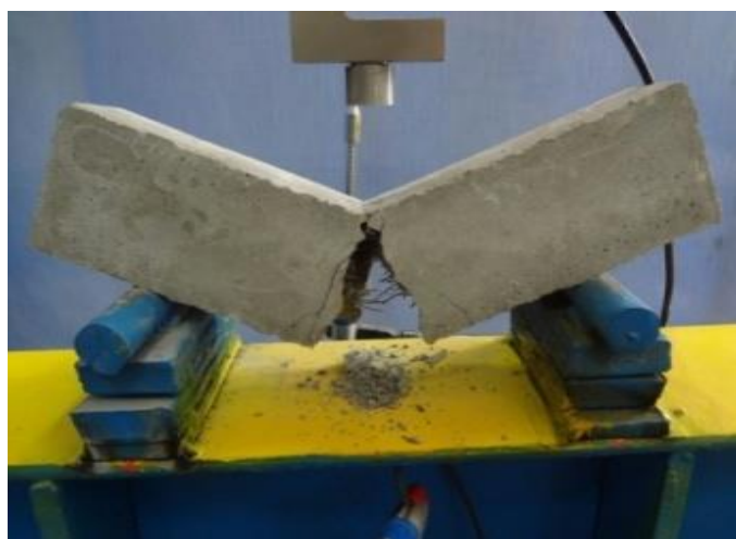
شکل ۸: نحوه انهدام تیر در دستگاه تعیین مقاومت خمشی
