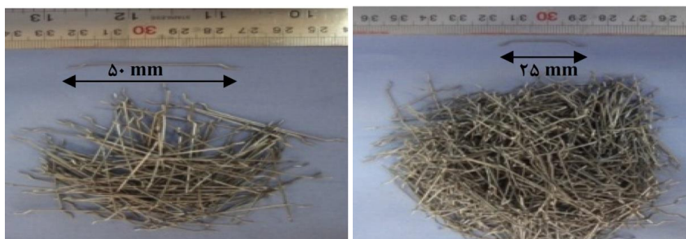
شکل ۱: الیاف مصرفی مورد استفاده
