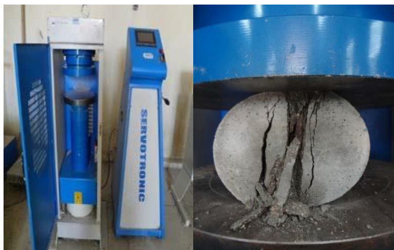
شکل ۴. نحوه انجام آزمایش تست کششی
