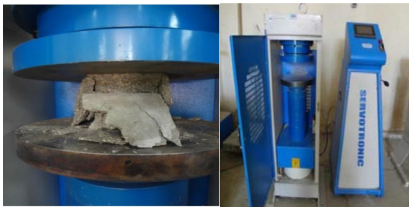
شکل ۴. دستگاه جک بتن شکن به همراه تصویر نمونه فشاری بعد از آزمایش
