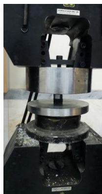
شکل ۲: نمونه‌های تست تعیین مقاومت فشاری
