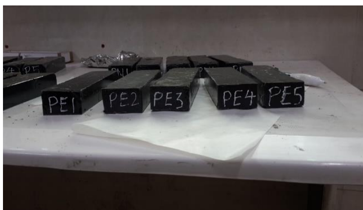
شکل ۴: نمونه های تست تعیین مقاومت خمشی
