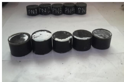
شکل ۵: نمونه‌های تست تعیین مقاومت کششی
