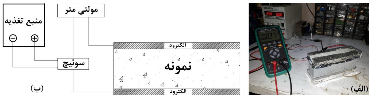
شکل ۱: تجهیزات اندازه گیری مقاومت الکتریکی: (الف) تجهیزات استفاده شده (ب) طرح شماتیک
