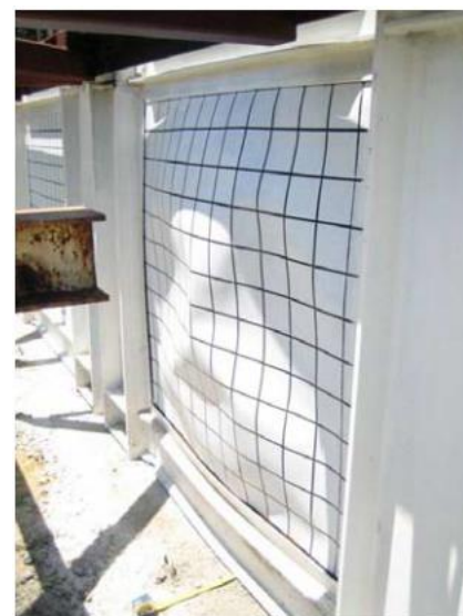
شکل (۲-۱). مدل آزمایشگاهی پس از موج اعمال انفجار، برگرفته از [۲۴].
