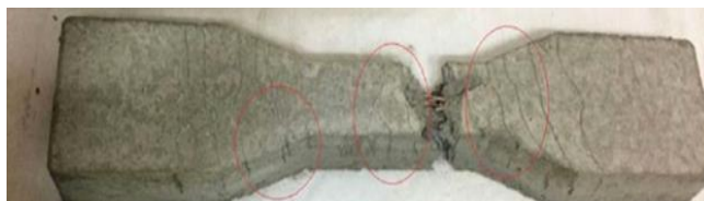
شکل ۳: نمونه ای از الگوی ترک خوردگی در نمونه HPFRCC.
