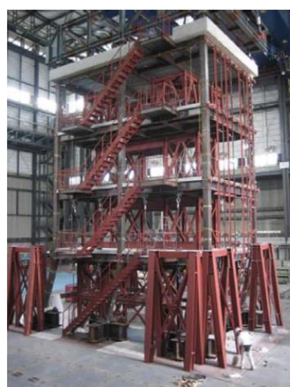
شکل ۵: نمایی از سازه مدل شده در ابعاد واقعی جهت آزمایش بر روی میز لرزان [۳۴]
