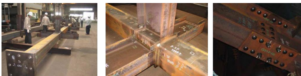
شکل ۳: نمایی از اتصالات مقاطع در مدل سازه‌ای [۳۲]
