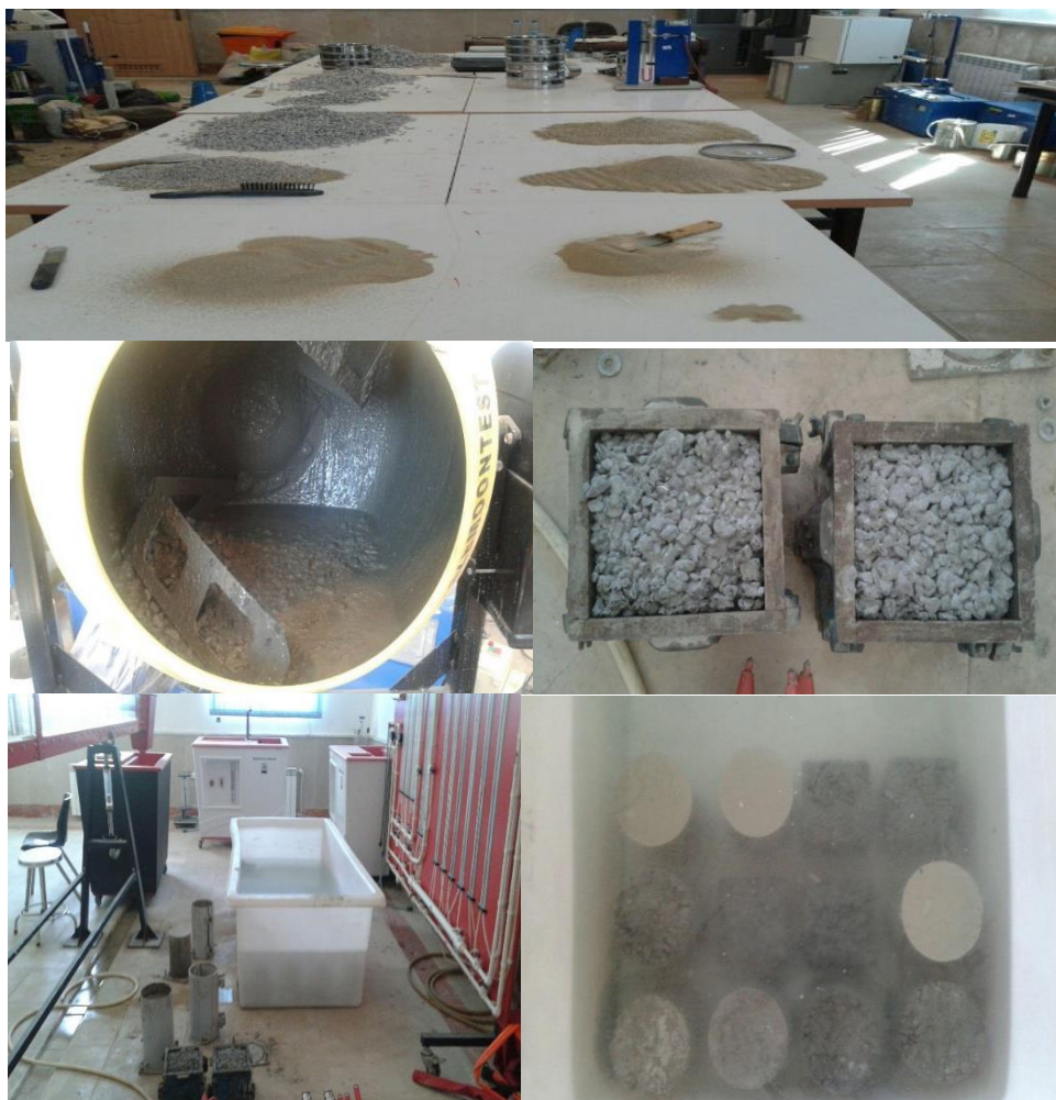
شکل ۴: تصاویر مراحل آماده سازی و ساخت و قالب‌گیری و عمل‌آوری بتن
