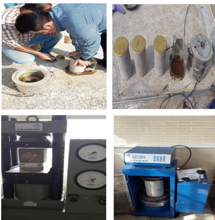
شکل ۴: نحوه کلاک گذاری و انجام آزمایش فشاری نمونه ها
