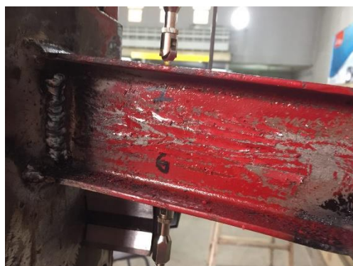
شکل ۱۰: شروع تغییر شکل در جان عضو زانویی و در نزدیکی تکیه‌گاه‌ها در هر دو نمونه
