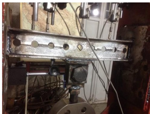
شکل ۱۰: شروع تغییر شکل در جان عضو زانویی و در نزدیکی تکیه‌گاه‌ها در هر دو نمونه
