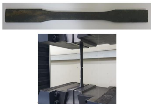
آ. منحنی تنش-کرنش مصالح فولادی به کار رفته در مطالعه ب. آزمون کشش استاندارد برای تعیین خصوصیات مصالح فولادی شکل ۳. خصوصیات مکانیکی مصالح فولادی به کار رفته در مطالعات آزمایشگاهی و عددی
