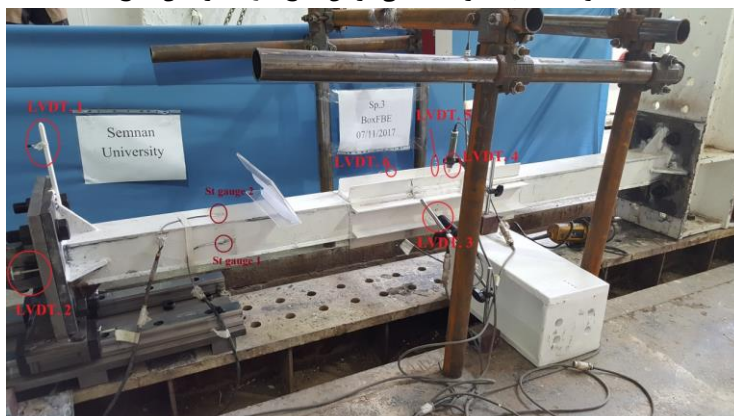
ب. نمونه BoxFBe به همراه جانمایی کرنش سنجه‌ها و تغییر مکان سنجه‌ها
