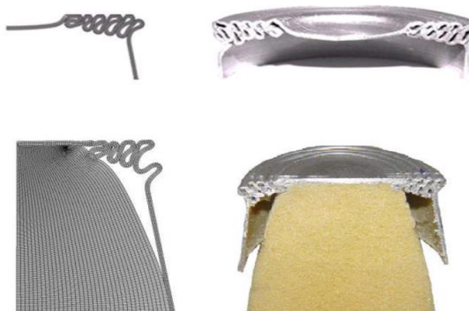
شکل ۴: فروریزش پوسته مخروطی توخالی و تقویت شده با فوم پلی یورتان تحت بارگذاری محوری
