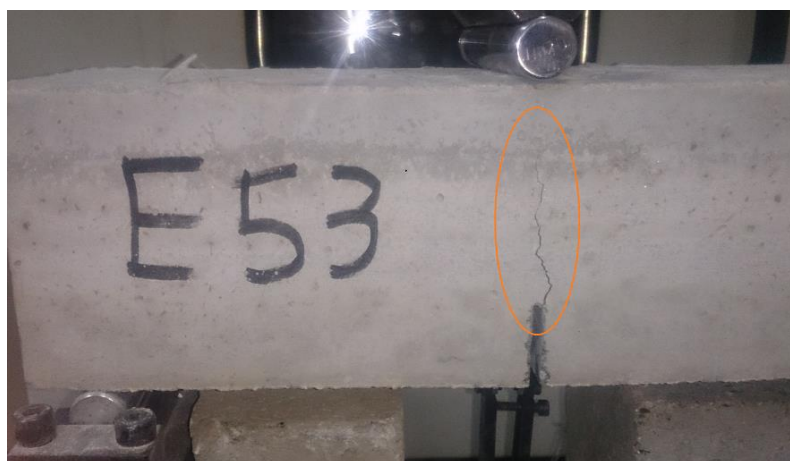
شکل ۵: نحوه ترک خوردن نمونه از ناحیه شکاف مرکز دهانه
