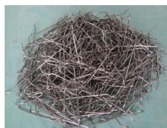
شکل ۱: الیاف فولادی و پلاستیکی مورد استفاده
