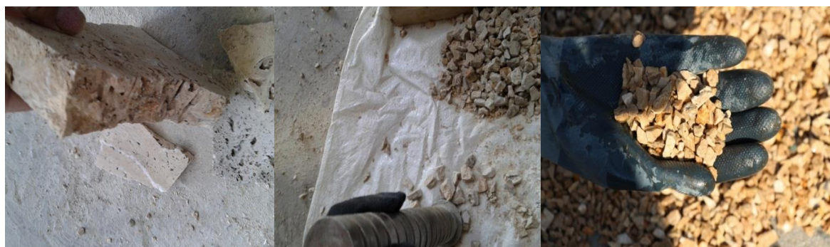
شکل ۳: تصاویری از سنگ تراورتن: الف) قبل از خرد شدن، ب) خرد کردن به وسیله چکش فلزی و ج) اندازه تقریبی مصرفی در تحقیق
