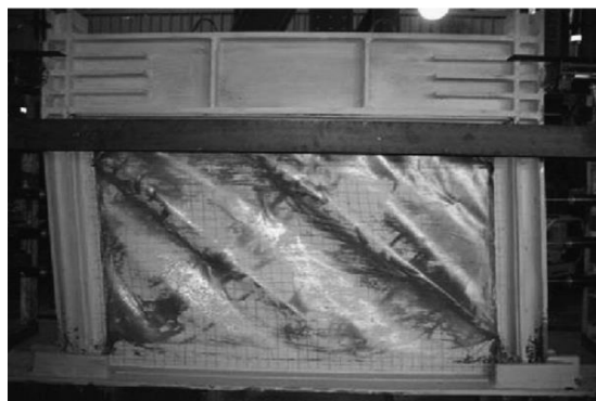
شکل ۷: نتایج آزمایش نیروهای جانبی بر روی نمونه آزمایشگاهی [1]
