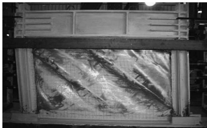
شکل (۷): نتایج آزمایش نیروهای جانبی بر روی نمونه آزمایشگاهی [۱۰]
