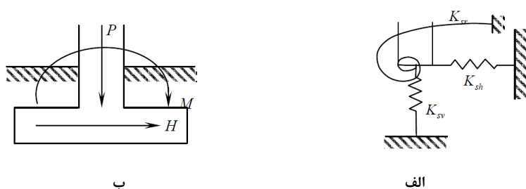
شکل ۵: مدل سازی پی با استفاده از فنر های غیر همبسته. الف) مدل فنر غیر هم بسته، ب) بارگذاری پی [۲۲]
