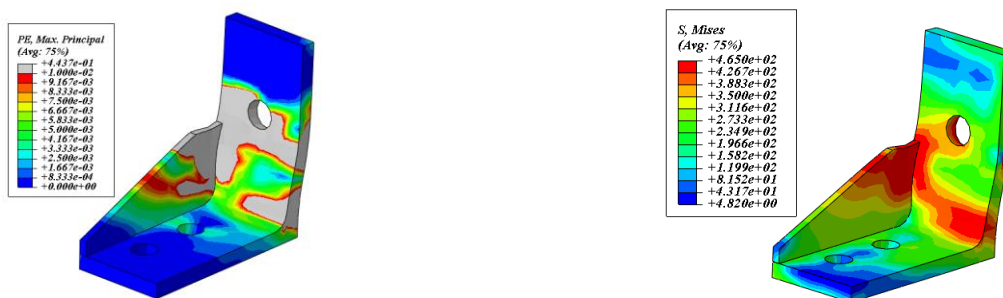
شکل ۱۶: توزیع تنش و کرنش در نبشی اتصال PC6-S2 در زاویه رانش نسبی ۳٪
