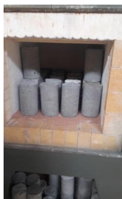
ت) طرز قرارگیری نمونه‌ها در داخل کوره الکتریکی
