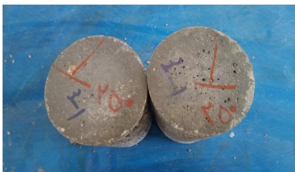
ب: رشد ترک در نمونه‌ی حاوی فنر در دمای ۲۵۰ درجه‌ی سانتی‌گراد
