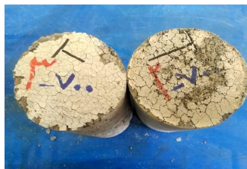
الف: رشد ترک نمونه‌ی حاوی فنر در دمای ۷۰۰ درجه‌ی سانتی‌گراد
