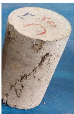
الف: نحوه‌ی قرارگیری نمونه‌ها در زیر جک ب: نحوه‌ی شکست نمونه‌ها پس از تست مقاومت فشاری شکل ۶: آزمایش مقاومت فشاری نمونه‌ها
