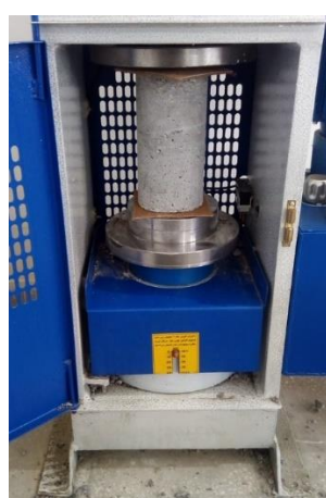
الف: نحوه‌ی قرارگیری نمونه‌ها در زیر جک ب: نحوه‌ی شکست نمونه‌ها پس از تست مقاومت فشاری شکل ۶: آزمایش مقاومت فشاری نمونه‌ها
