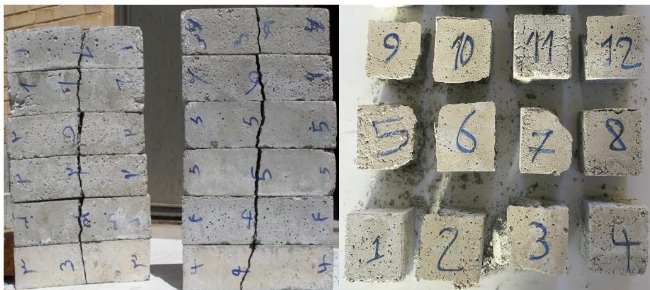
شکل ۲: نمونه‌های فشاری و خمشی ساخته شده پس از انجام آزمایش
