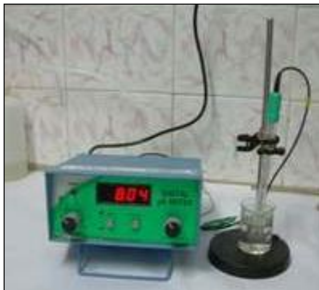
شکل ۴: دستگاه تعیین مقدار اسیدیته گروت (pH meter)
